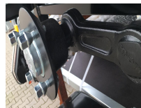
Essieu non freiné 750 kg : Moyeu surdimensionné et bras en acier forgé
